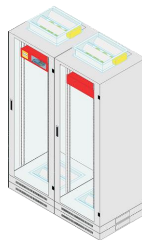
Rys. 2. Główne elementy składowe automatycznego systemu gaszenia i doszczelnienia
