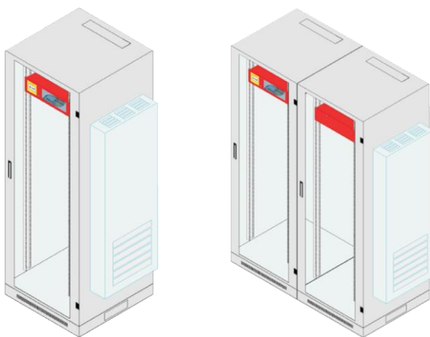
Rys. 3. Szafy o podwyższonej szczelności \geq IP54 z klimatyzatorem i automatycznym systemem gaszenia
